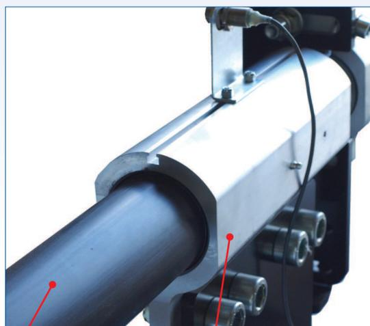
Guida in alluminio estrusa in lega di alluminio ad alta resistenza e con trattamento superficiale contro corrosione, usura, incisioni e graffiature
