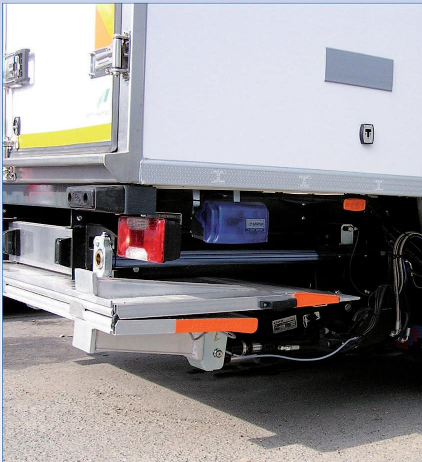
Sponda retrattile posteriore a singolo ripiegamento a 4 cilindri.
